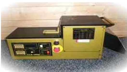
Machine à couper les gaines thermo-rétractables
