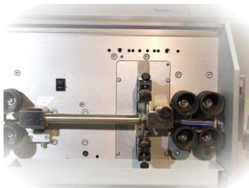
Machine à couper et dégainer les câbles et fils KOMAX K235 et KOMAX 220
