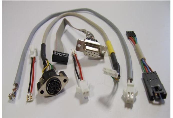
Faisceaux divers pour les luminaires et l'électronique
