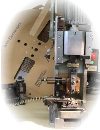
Presses à sertir électromagnétique avec mini-applicateur
